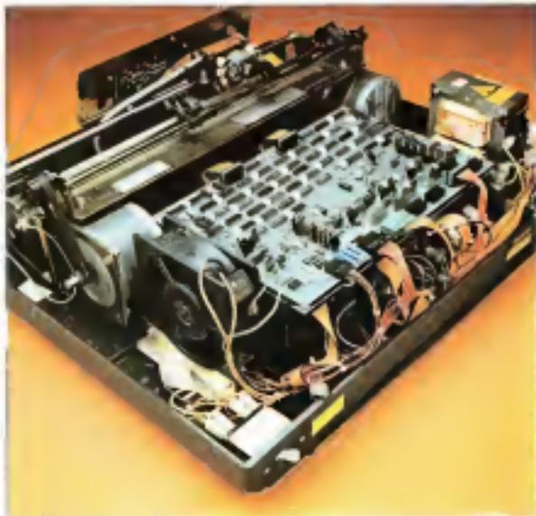
*Il sistema rivela una costruzione solida e razionale. Nella foto sopra si notano in primo piano la grande ventola per il raffreddamento a olio che assicura il corretto funzionamento della carta, il sistema della bobina con compensatore. Sul fondo della stessa foto si intravedono il registratore di almeno cinque e il secondo motore (che dà il movimento alla testa di scrittura) meglio visibile nella foto in basso.*
